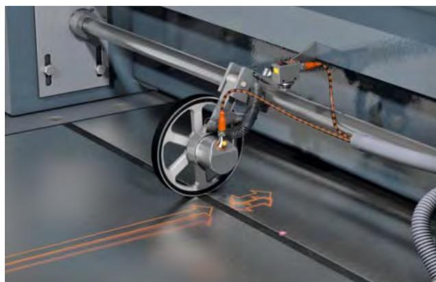
El objeto se detecta mediante un sensor de posición y la posición final se transmite en tiempo real a través de la entrada directa en el encóder. Esto permite ajustar el encóder a un valor predefinido (p. ej. cero) sin desajuste temporal o mecánico a través del PLC, para poder medir el objeto con la máxima precisión. Las tareas posteriores, como el aserrado u otros procesos de mecanizado, se pueden activar. También se ven reducidos los costes y la complejidad de cableado.
